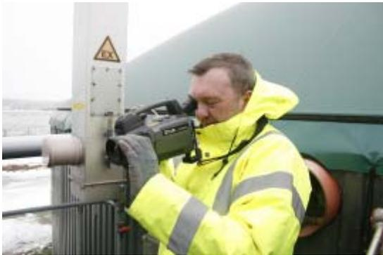
Mit einer Gaskamera lassen sich Lecks in der Folienhaube schnell auffinden. Foto: Neumann. Mit der Gaskamera Methanlecks finden, neue Sicherheitsregeln für Biogasanlagen , Abwärmeverstromung mit ORC- Anlagen oder Emissionsverhalten von Gasmotoren sind nur einige der Themen, die auf der Internationalen Bio- und Deponiegas - Fachtagung mit Ausstellung in Kiel zur Sprache kommen.
